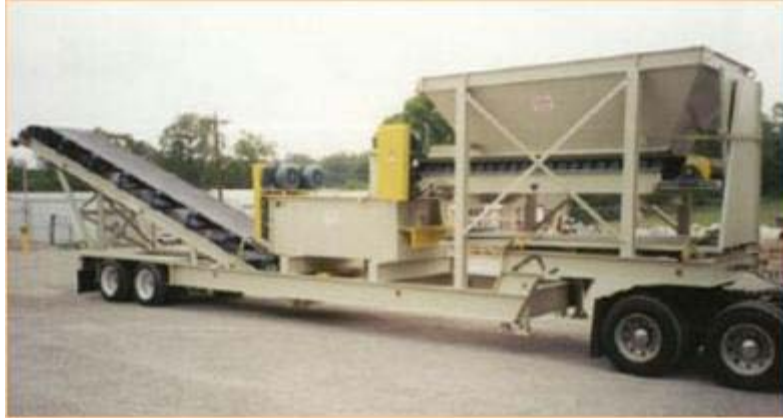
Foto 5: Equipo para tratamiento de estabilización/solidificación en operación continua tipo pac mill.
